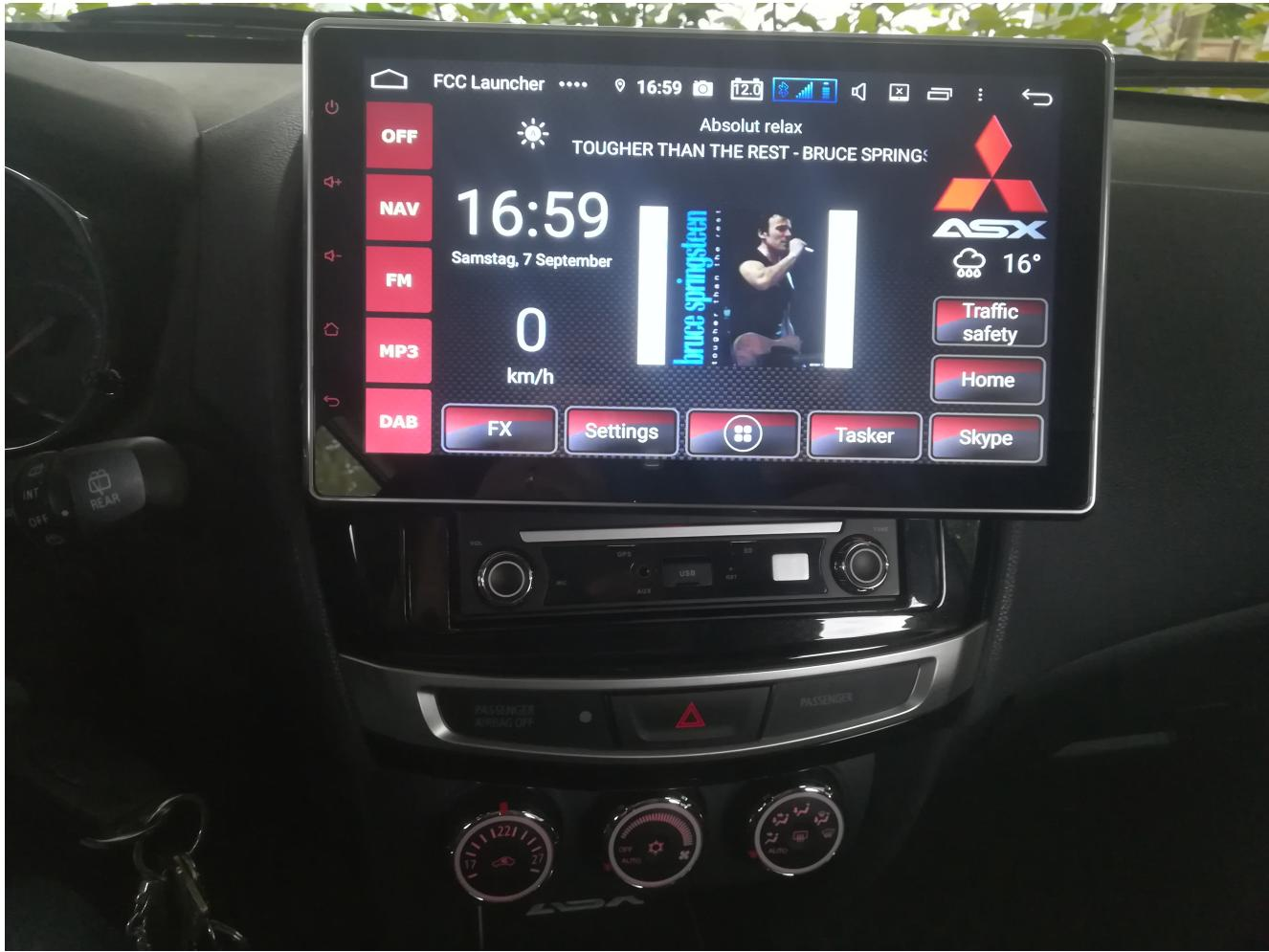
Der Bildschirm wird mittels Flachkabel-Stecker am Radio angeschlossen, einfach nur drauf geschoben und rastet ein. Man kann den Bildschirm mit ein wenig Kraftaufwand in allen Richtungen drehen, dabei macht die Halterung einen sehr stabilen Eindruck. Da rappelt auch nichts.
