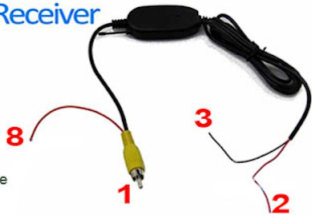
Wenn Ihre Kamera keinen umgekehrten Detektiv Draht, und Ihr Monitor erfordert das Kabel angeschlossen werden, um den Monitor zu wechseln automatisch, Rückfahrkamera Bild anzeigen auslösen, dann müssen Sie möglicherweise das umgekehrte detective Kabel vom Monitor erweitern, und bis zu den Kofferraum des Autos Draht und an der Auto-Rückfahrcheinwerfer 12V-Pluspol angeschlossen.
