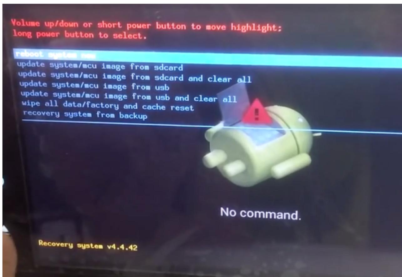
Dann Taste Power oben und unten wechseln, langer Druck Option auswählen“update system/mcu image from sdcard and clear all”. Der Update-Vorgang erfolgt automatisch durch das Autoradio selbst, Im folgenden finden Sie eine Videoanleitung zum Nachschlagen.
