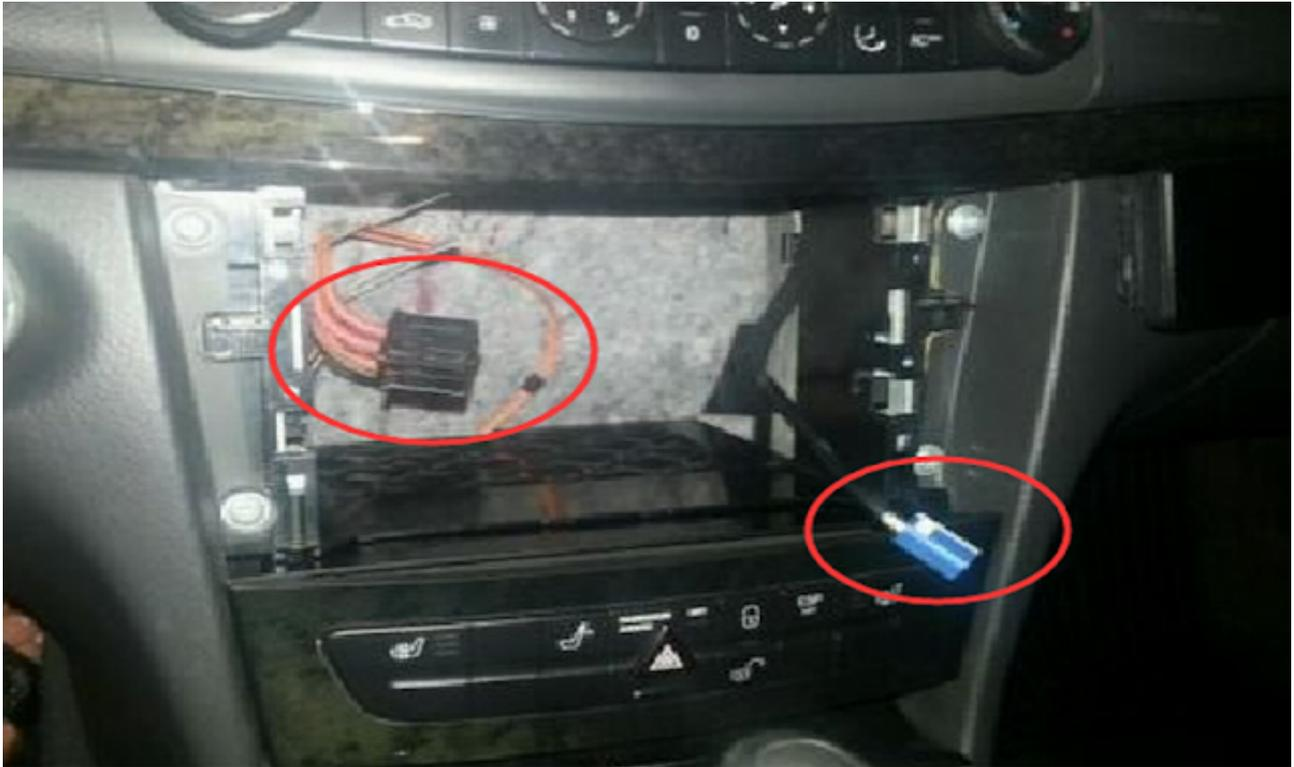
Nach dem entfernen Ihre original-Radio, finden Sie zwei Kabelbaum wie das obige Bild zeigt. Bitte lassen sie allein. Sie müssen nur das Stromkabel von uns mit unserer Einheit zu verbinden. Und Bitte beachten Sie, dass die Canbus-Box angeschlossen werden sollte, sonst wird das Gerät nicht einschalten, weil, schalten Sie das Autoradio das Canbus Signal Decodieren von Ihrem Auto braucht.
